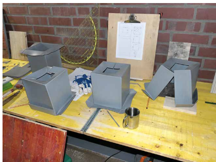
Abb. 28 + 29: Handwerklich gefertigte Formstücke für Detailabdichtungen
