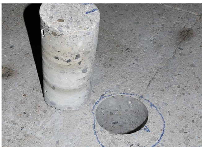
Abb. 19 + 20: Bohrkernprobennahme in einem Rissbereich der Betonbodenplatte mit sichtbarem Trennriss
