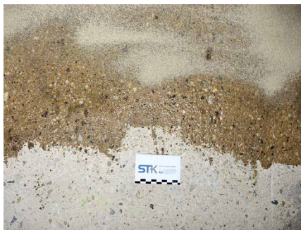
Abb. 24 + 25: Epoxidharzgrundierung mit Quarzsandabstreung
